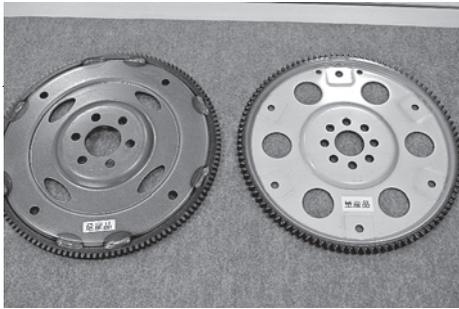
左/リングギア一体ドライブプレート。世界初の独自の板鍛造技術を活かした代表的製品
