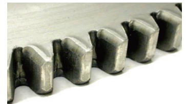
増肉歯形成形による歯車。 上方からの荷重により環状の外側に座屈する現象を活用して、歯車形に成形している。
