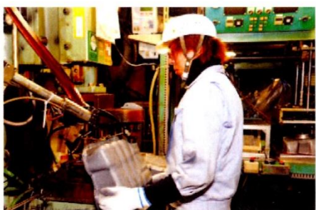
分厚い金属をプレス加工し、自動塗装の後に焼き入れ。完成品は1枚ずつ検査して万全を期している。
