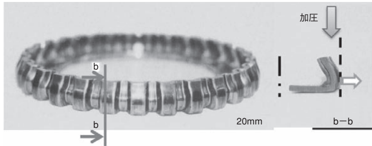
図5 端面鍛圧時の座屈現象例
